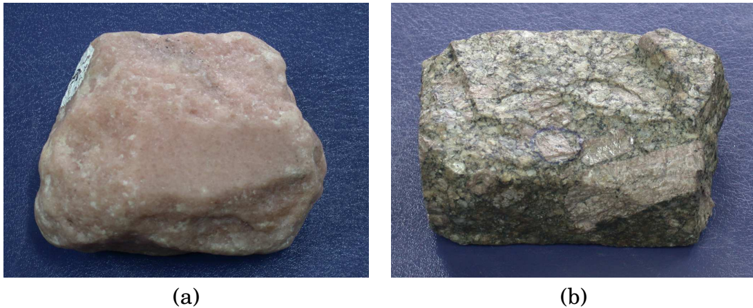
GAMBAR 7.1: Contoh batuan kristalin. (a) marmer yang monomineral, dan (b) monzonit kuarsa yang polimineral
