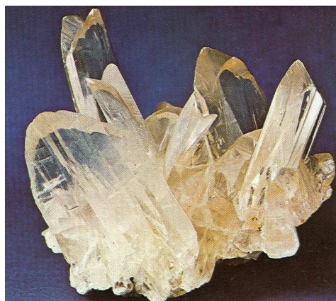
GAMBAR 5.7: Kristal gipsum dengan struktur kristal monoklin
