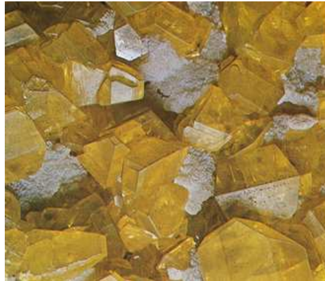
GAMBAR 5.6: Belerang murni dalam bentuk kristal ortorombik
