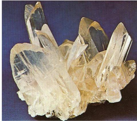
GAMBAR 5.7: Kristal gipsium dengan struktur kristal monoklin
